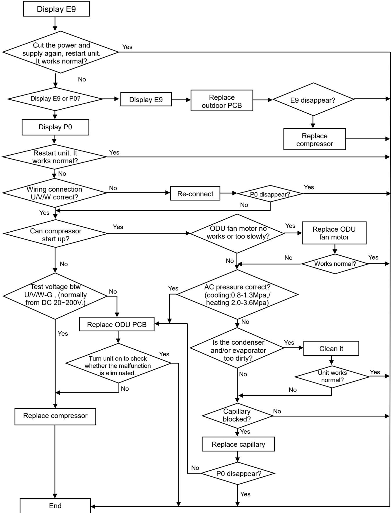
8.7 EF---ODU DC fan motor failure
